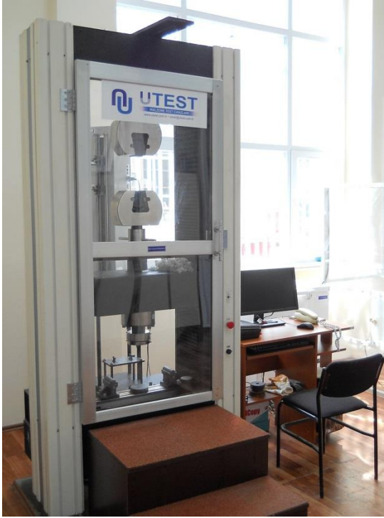
Şekil 3.2. UTEST marka 250kN kapasiteli çekme test cihazı ve otomatik ekstensometre
