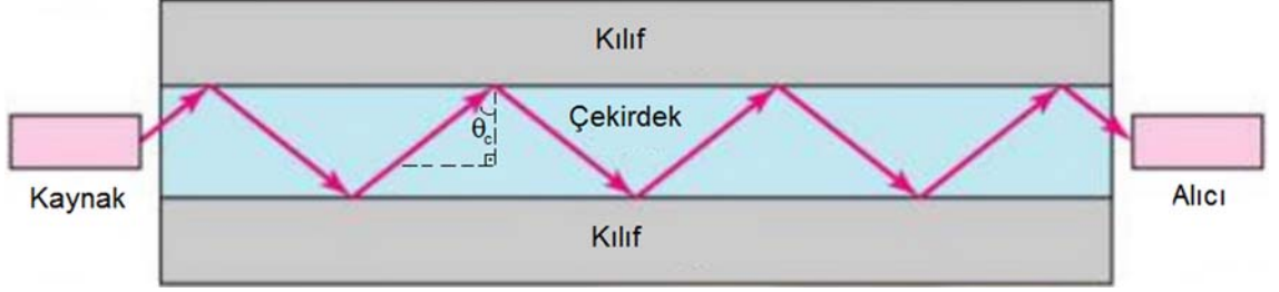
Şekil 2.9. Fiber optik içerisinde tam yansımanın kullanılması.
