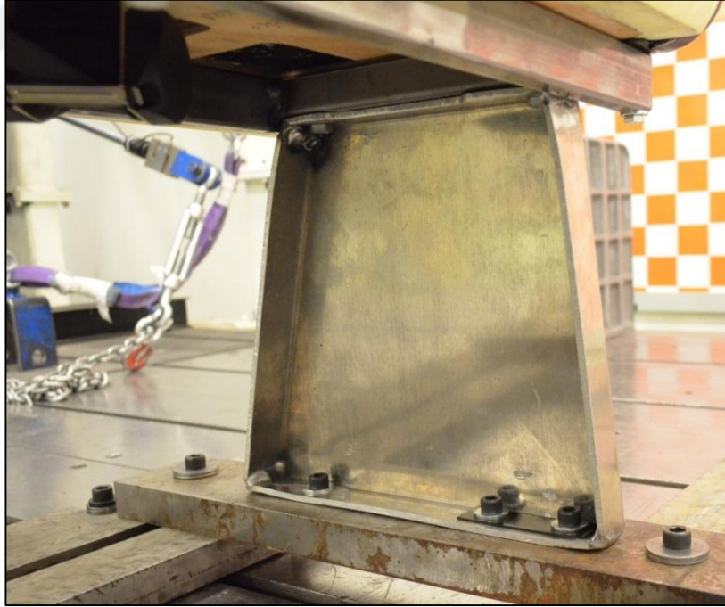
Şekil 4.36. Al 5754 H22 ECE R-14 emniyet kemer çekme fiziksel test sonrası sağ ayak görünümü
