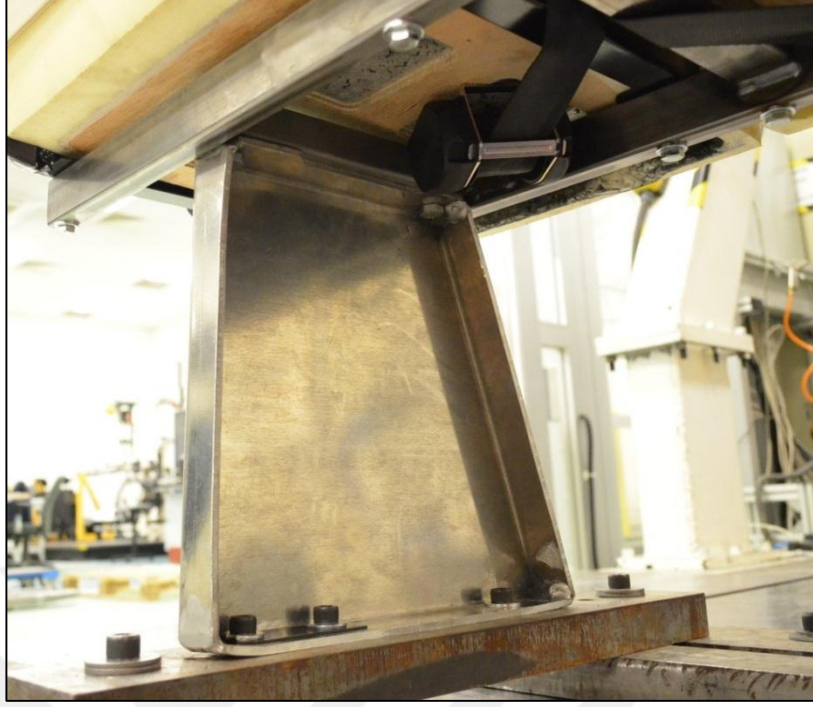
Şekil 4.35. Al 5754 H22 ayak malzemesi ECE R-14 emniyet kemer çekme fiziksel test sonrası sol ayak görünümü
