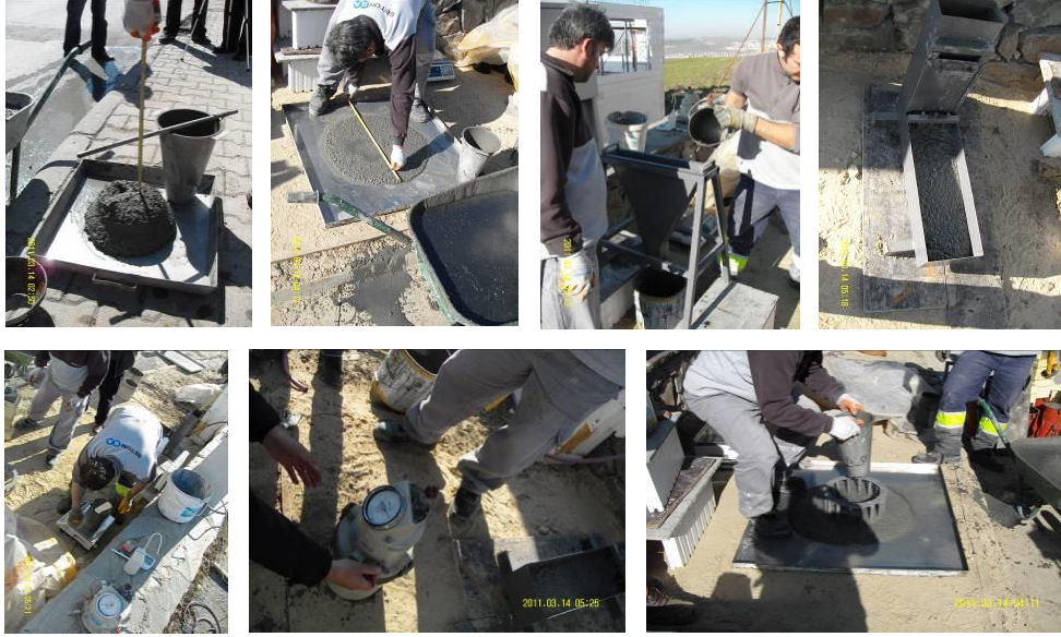
Şekil 5: Çalışma Kapsamında Yapılan Taze Beton Deneyleri (Özşahin, 2011)
