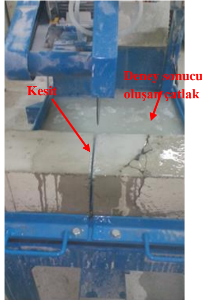
Şekil 2: Numunelerin Kesim İşlemi
