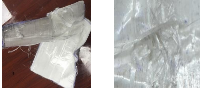
Şekil 7: Atış sonrası UHMWPE katmanlı kompozit yapı
