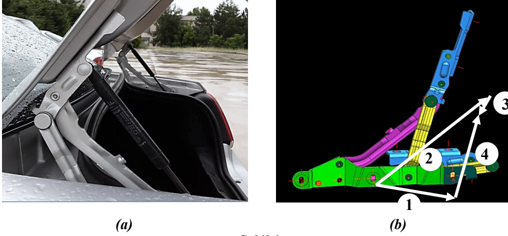
Şekil 1: Gazlı pistonlu bagaj kapağı açma-kapama mekanizması.
