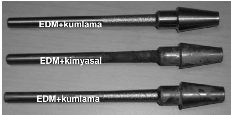
Şekil 5: Tornalamadan sonra yapılan EDM, EDM+kimyasal işleme ve EDM+kuşlama işlemlerine tabi tutulmuş üç tip numune örneği.
