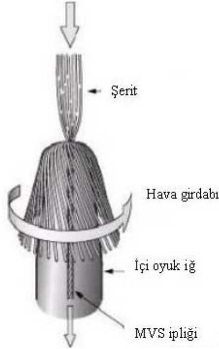
Şekil 3: Murata vortex sisteminde iplik oluşumu [4].
