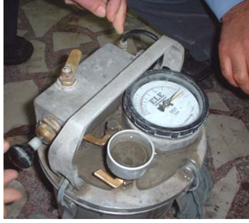
Şekil 3: Taze betonda hava boşluğunun belirlenmesi (Şimşek 2005)
