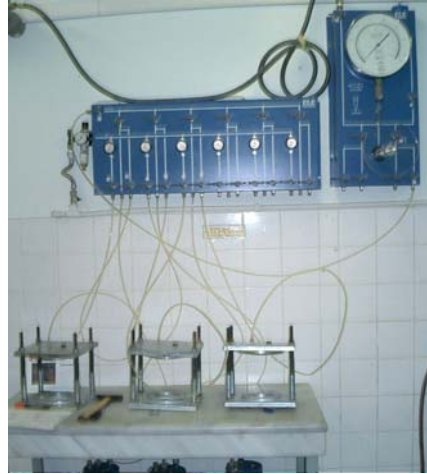
Şekil 4: İmpermeabilite aleti (Şimşek 2005)
