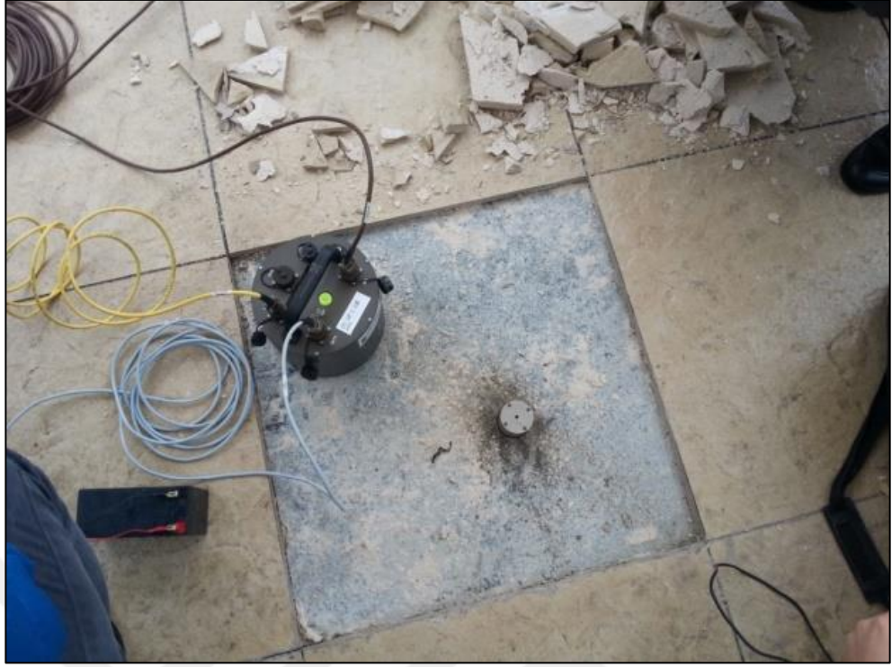
Şekil 3.41. CMG-5TCDE ve KB12VD ivmeölçerlerinin yerleşimi genel görünümü
