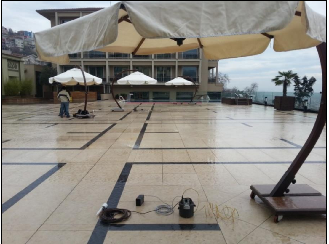
Şekil 3.42. Seramik kaplama üzerine yerleştirilen CMG-5TCDE ivmeölçer kullanımı
