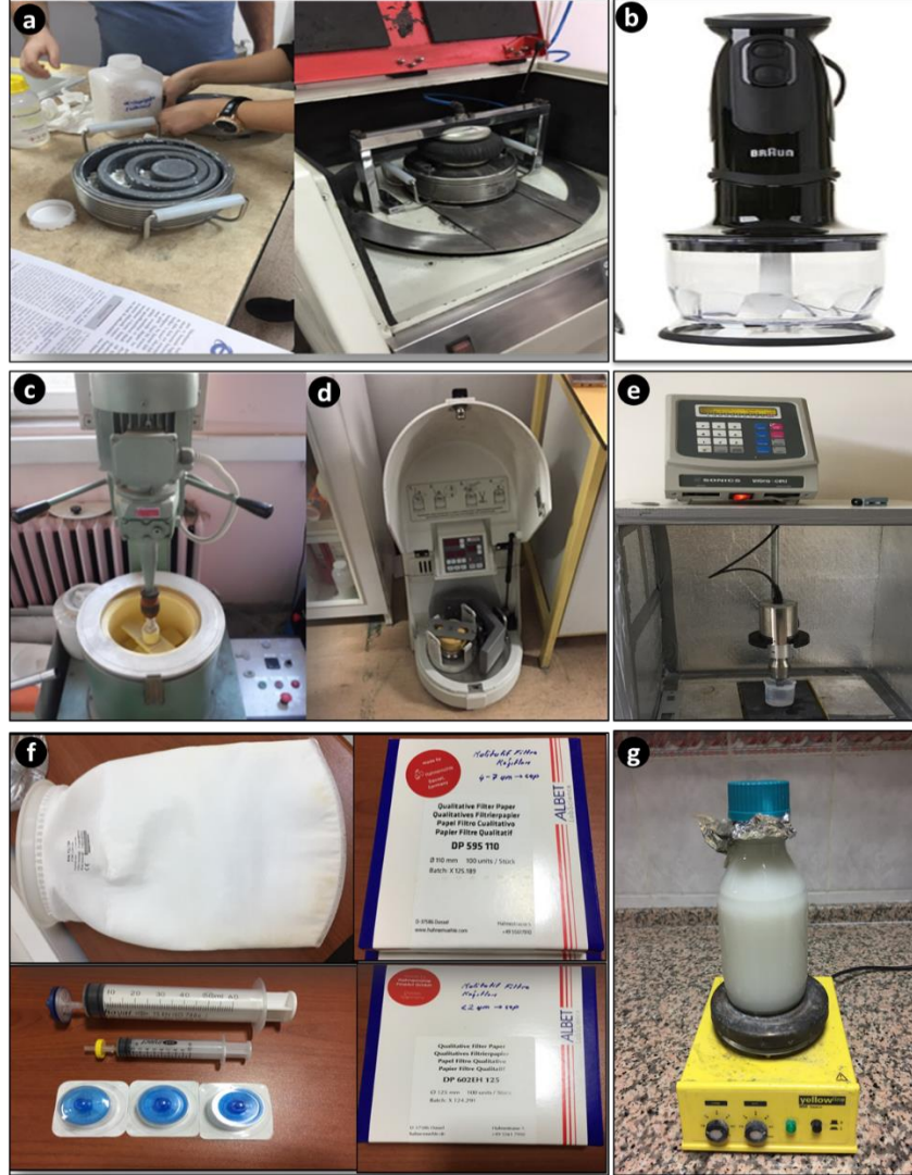
Şekil 3.2. Nano alfa sepiyolitinin üretim aşamaları a) Halkalı değirmen b) Braun marka mekanik dağıtıcı c) Atritör değirmen d) Bilyalı değirmen e) Sonikatör f) Çeşitli filtrasyon gereçleri g) Manyetik karıştırıcı
