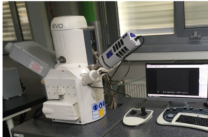
Şekil 3.5. Zeiss EVO50 SEM ve EDX Cihazı
