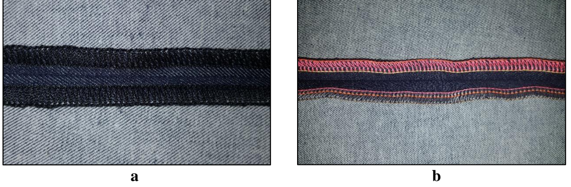
Şekil 4.26. a- Klasik overlok makinesi, b- Sürfile Otomatı ile dikilen ET5 numunesinin yıkama öncesi görüntüsü
