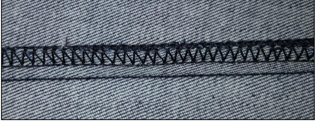
Şekil 4.6. Denim üreticisi firmada E3 kodlu kumaşa yapılan sürfile dikiş (3 dikiş/cm)
