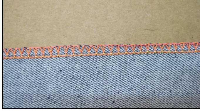
Şekil 4.15. Karşılıklı Çift Kafalı Sürfile Otomatı ile E3 kodlu kumaşa yapılan sürfile dikişleri (3 dikiş/cm)
