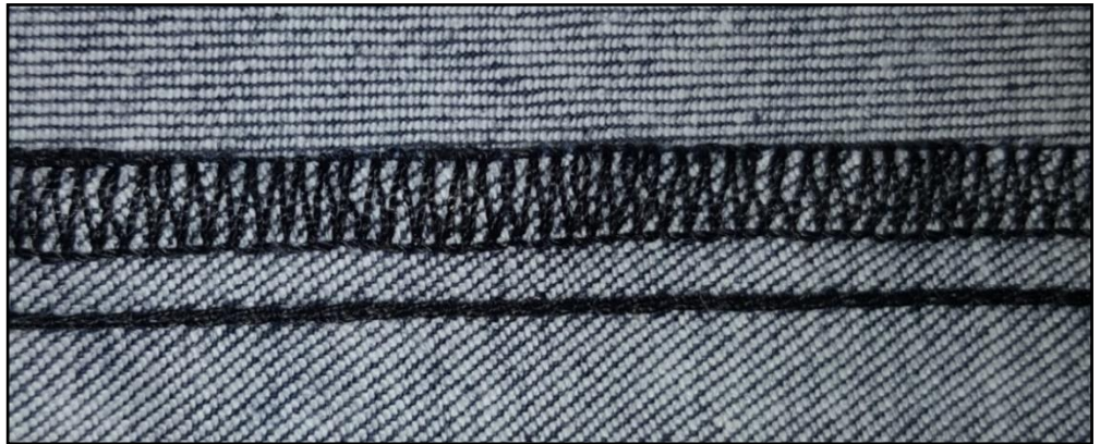
Şekil 4.8. Denim üreticisi firmada E5 kodlu kumaşa yapılan sürfile dikiş (5 dikiş/cm)
