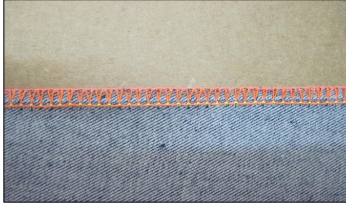
Şekil 4.19. Karşılıklı Çift Kafalı Sürfile Otomatı ile ET4 kodlu kumaşa yapılan sürfile dikişleri (4 dikiş/cm)
