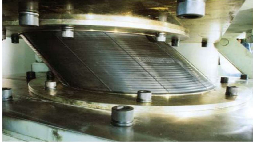
Şekil 2.7. Kauçuk esaslı elastomerik izolatörün testler sırasındaki şekil değişimi
