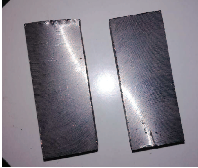
Şekil 4.2. 50 x 20 x 12 mm dayama parçası
