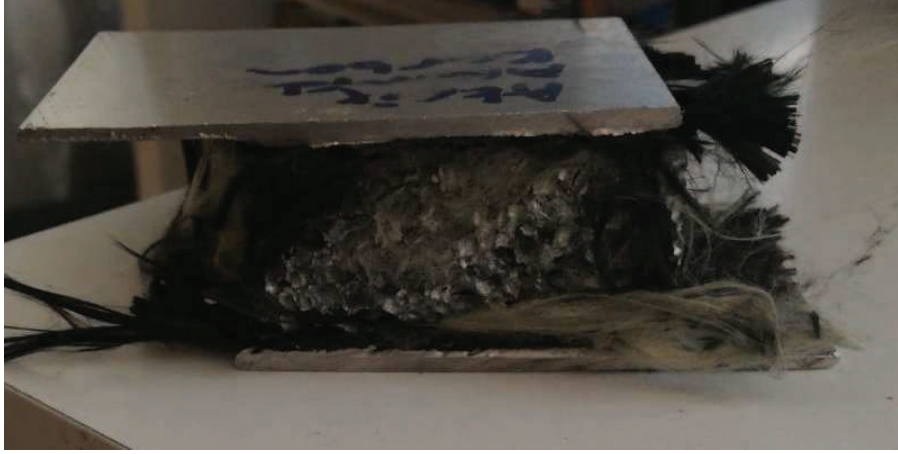
Şekil 3.22. Akfix-Aramid- Karbon elyaf sandviç yapısı
