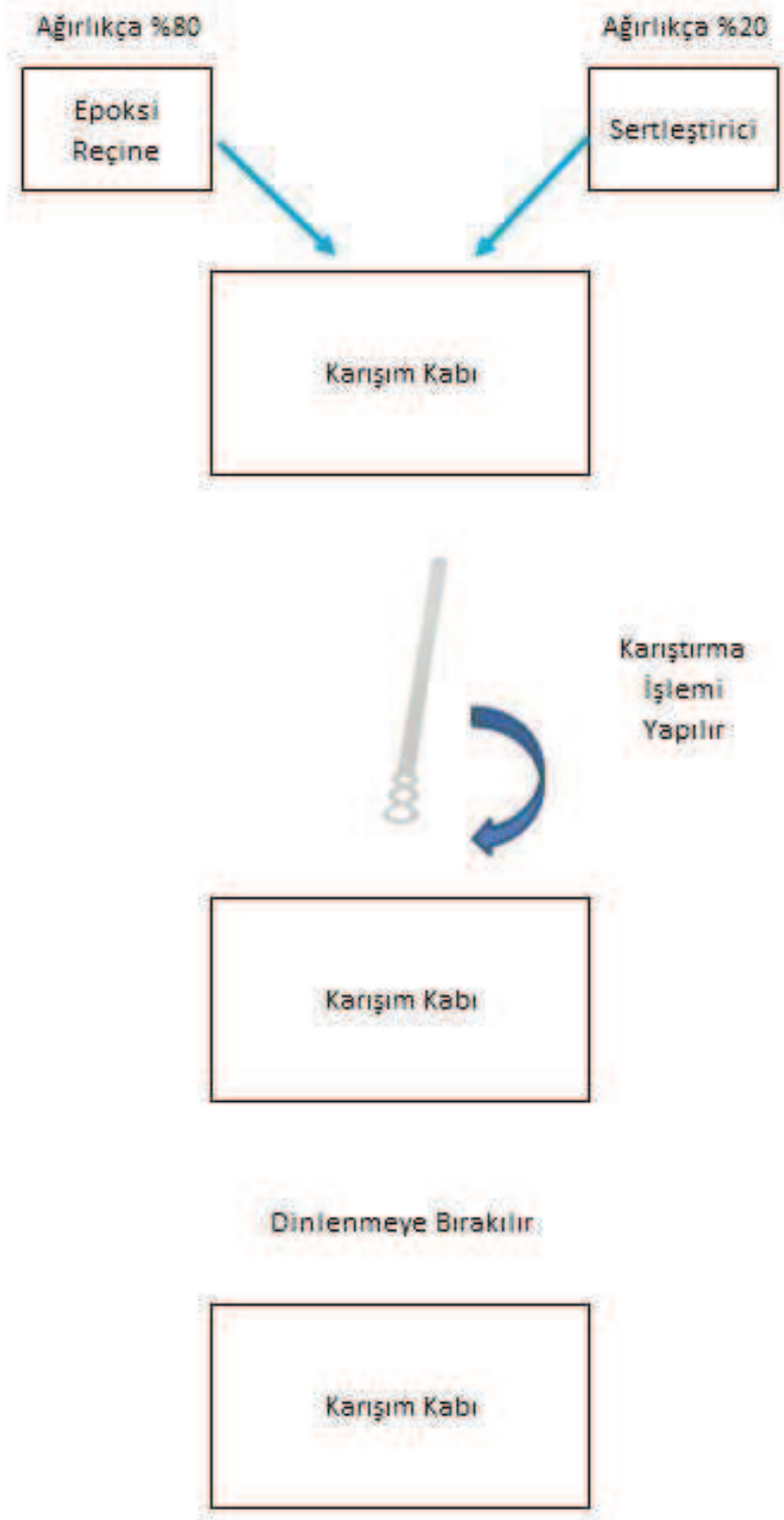
Şekil 3.6. Döküm Tipi epoksi reçinenin hazırlanma şeması
