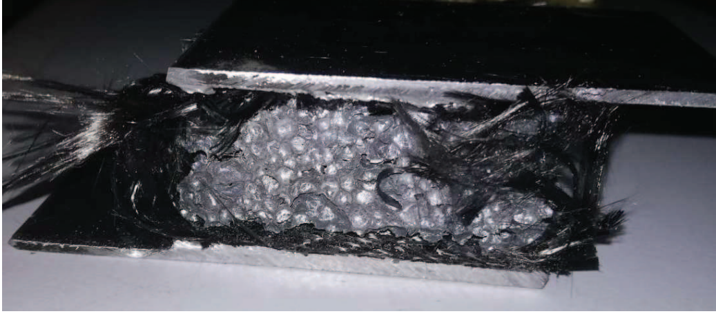
Şekil 3.21. Akfix- karbon elyaf sandviç yapısı
