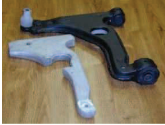
Şekil 2.9. İçerisine Al köpük konularak desteklenmiş süspansiyon parçası (Simancık 2001).
