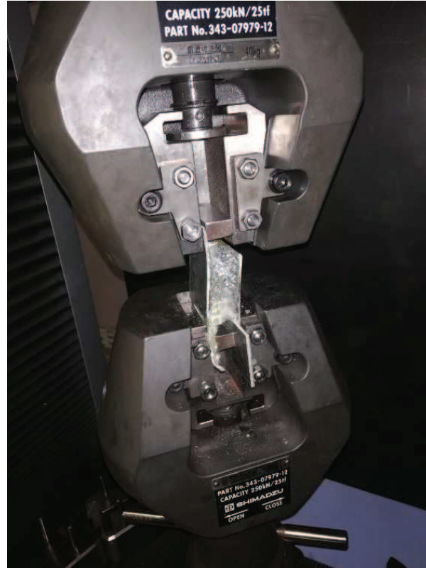
Şekil 4.3. Örnek Çekme testi yapılma anı.
