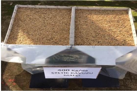
Şekil 3.6. Çeltik kavuzu uygulanmış ve yapay yağış uygulanmasına hazırlanmış erozyon parselleri (a, b, c, d, e, f).
