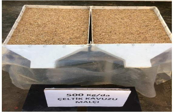
Şekil 3.6. Çeltik kavuzu uygulanmış ve yapay yağış uygulanmasına hazırlanmış erozyon parselleri (a, b, c, d, e, f).
