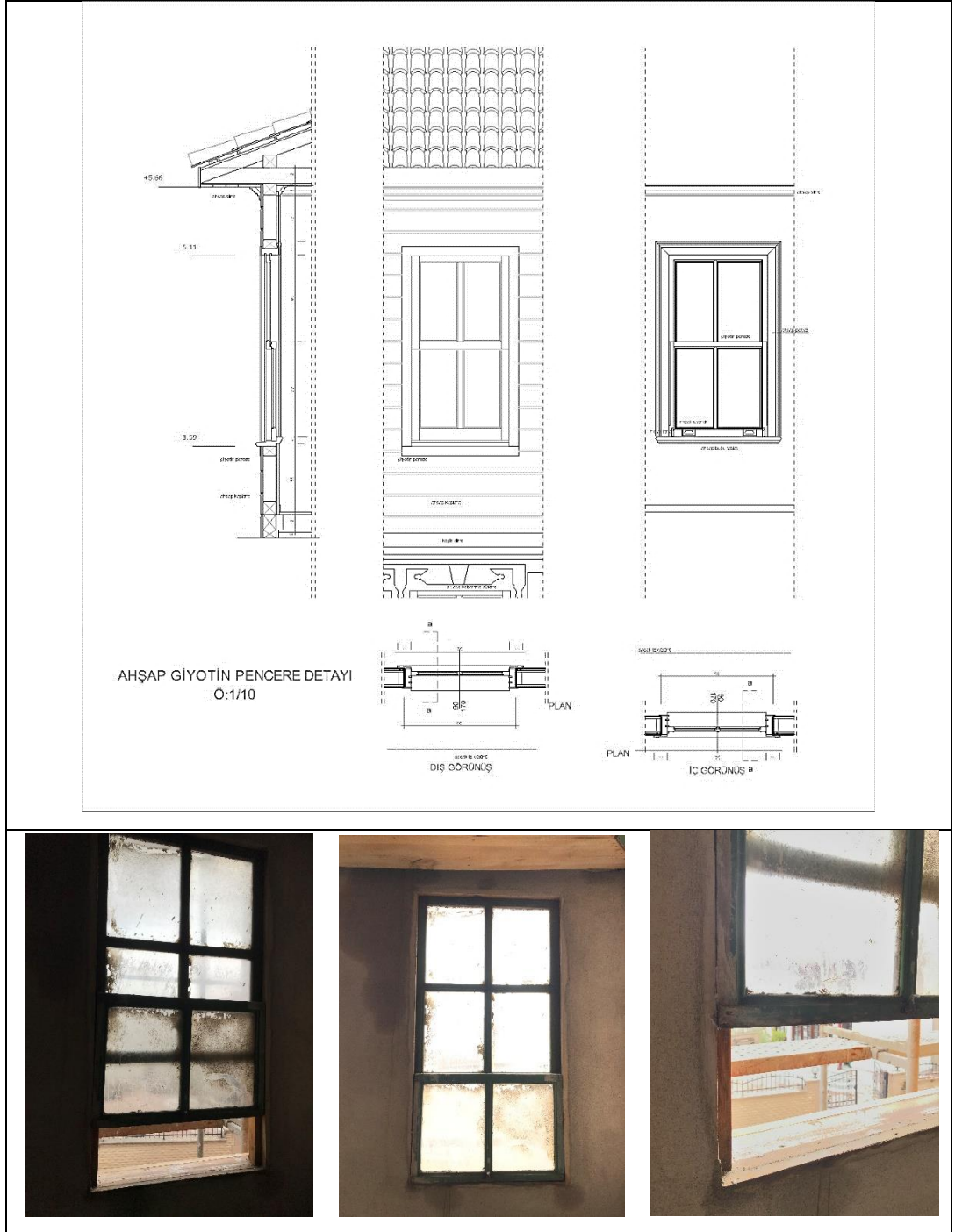
Şekil 3.61. Giyotin pencere detayı (Göktaş 2019)
