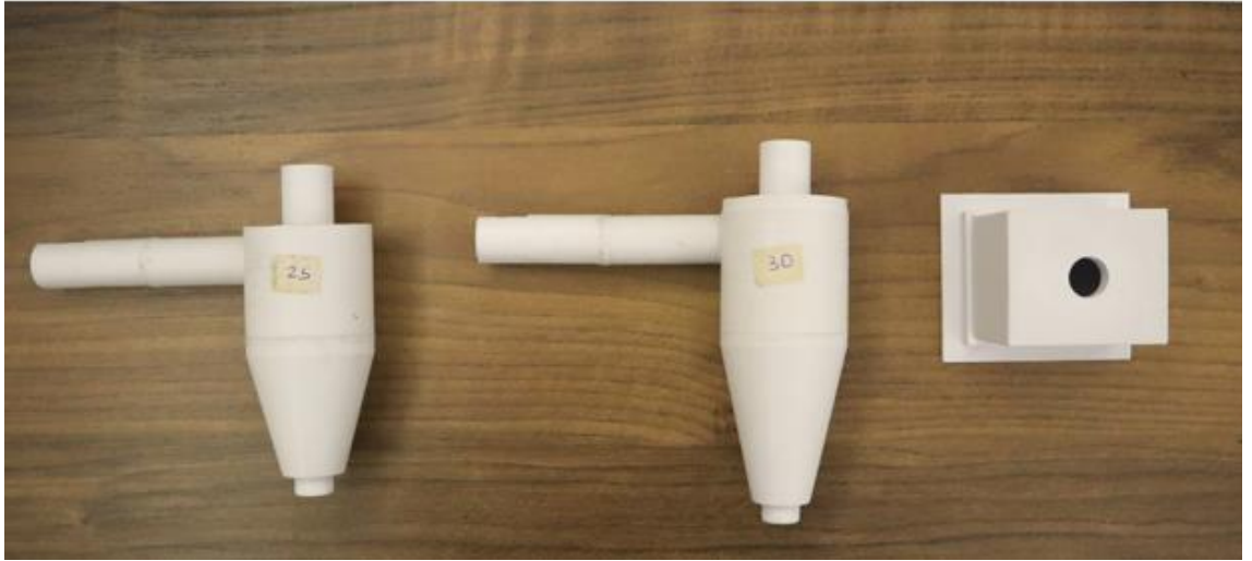
Şekil 3. 2. İmal edilen Stairmand tipi mini siklon ayırıcılar ve toz kutusu
