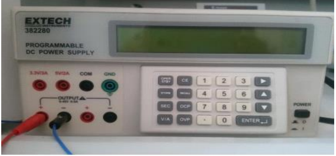
Şekil 3.4. Deneysel çalışmalarda kullanılan doğru akım güç kaynağı Kullanılan pH metre ve terazi Şekil 3.5 ve Şekil 3.6’da sırasıyla gösterilmiştir.
