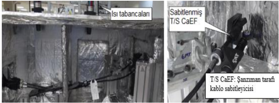
Şekil 4.1. Kırılma yükü test düzeneği
