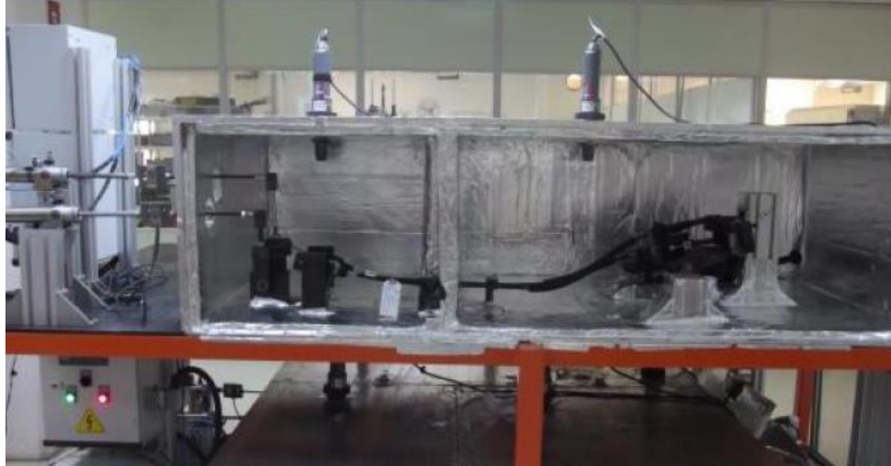
Şekil 2.29. VKK ömür testi için hazırlanan test masası (Ficosa Otomotiv 2015)
