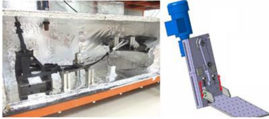
Şekil 2.32. Salınım testi mekanizması ve ekipmanı (Ficosa Otomotiv 2011)
