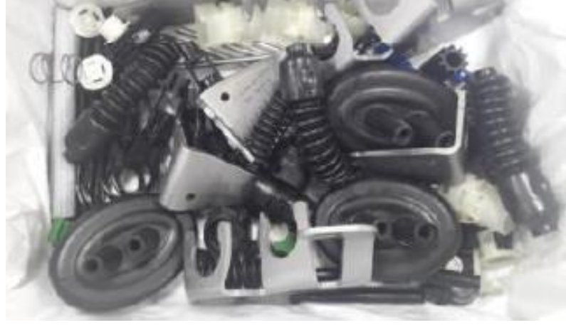
Şekil 2.31. Kimyasal dayanım testi sonucu kablo parçalarının genel görünümü
