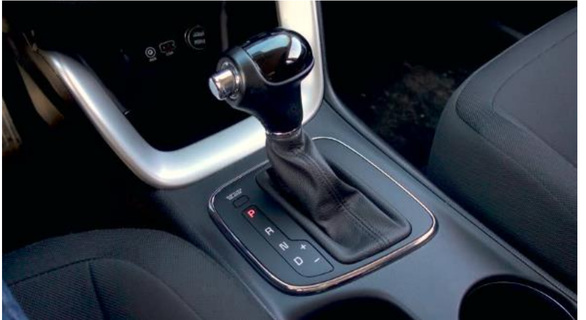
Şekil 2.4. Otomatik bir vites kumandasının adımlarının üstten görünümü
