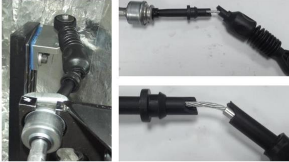
Şekil 4.14. T/S'de yaşanan kırılma
