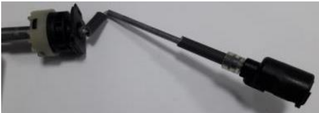
Şekil 4.11. Test sonrası kırılan salınım tüpü
