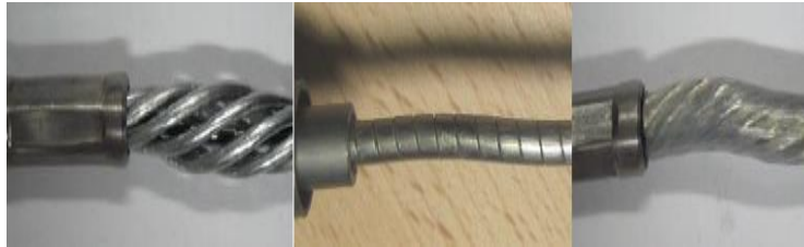
Şekil 2.22. Farklı türlerde iç tellerin basma yükü testlerin deformasyona uğraması (Technical dossier for shifter cables, Ficosa 2010)
