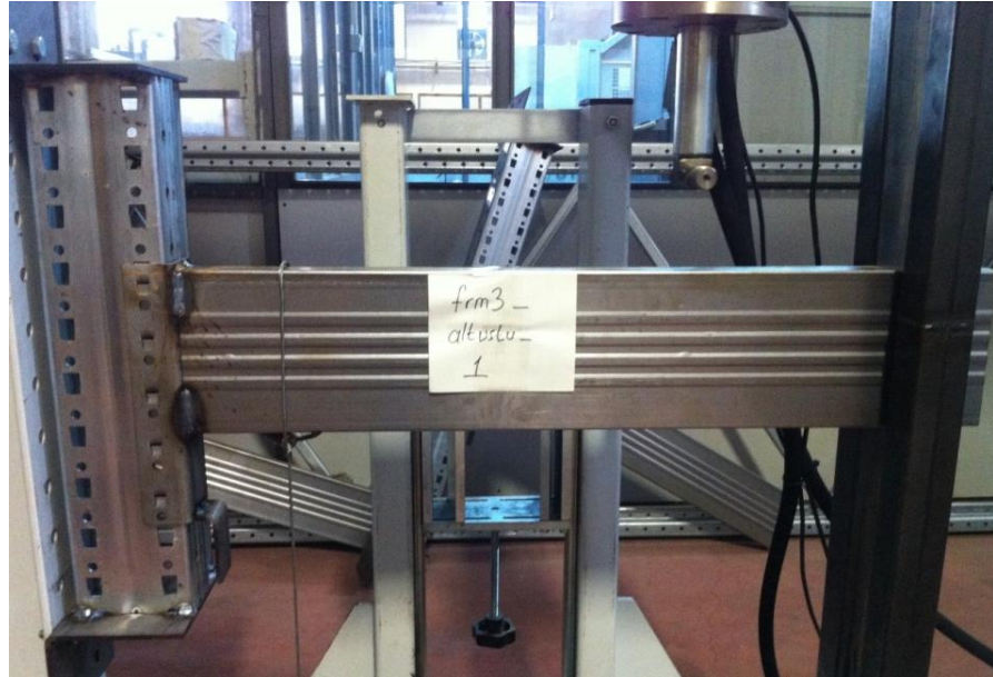
Şekil 4.5. Alt-üst U kaynaklı yatay taşıyıcının konsol testi kurulumu
