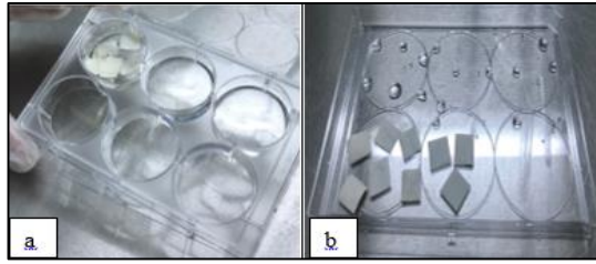
Şekil 3.20. Sterilizasyon işlemi; a) sterilizasyon çözeltisine numunelerin daldırılması, b) UV ışık altında yarım saat ön ve arka yüzeyin bekletilmesi
