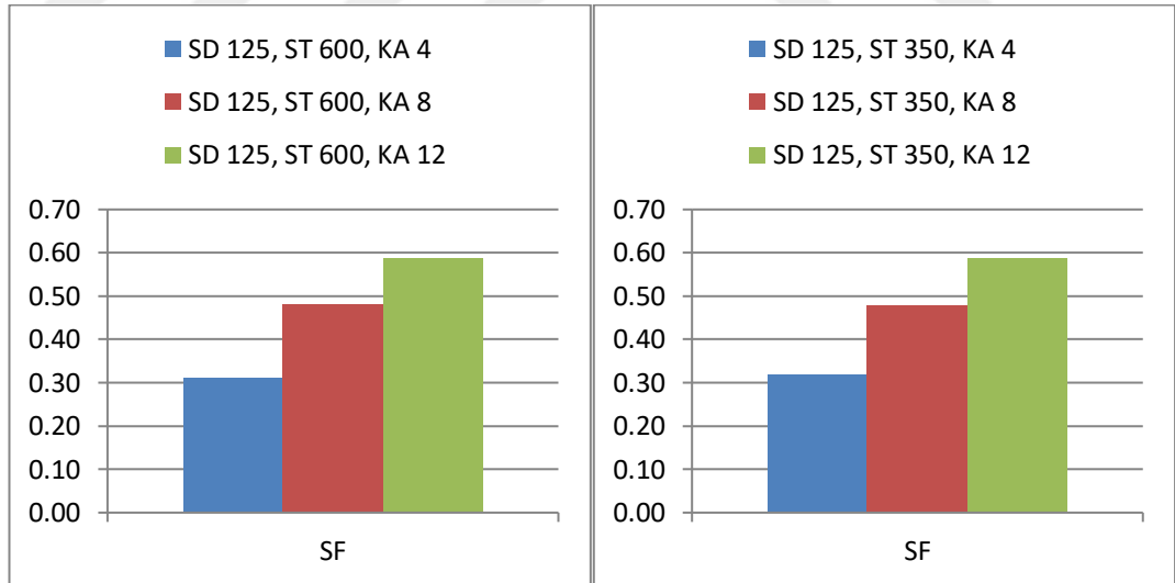
Şekil 4.35. 125 m sondaj derinliği için, tank hacmi ve kolektör alan değişimlerinin SAGSHP sisteminde SF üzerine etkisi
