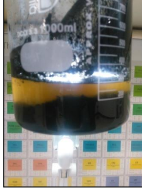
Şekil 4. 1. Reçinenin metil etil ketonda çözünmesi
