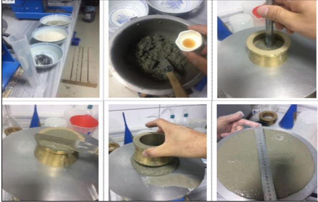
Şekil 3.1. Üç farklı karışım için yayılma deneyleri (Mirkheel 2018)
