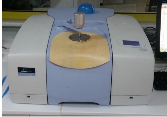
Şekil 3.6. Fourier dönüşümlü kızılötesi spektroskopisi
