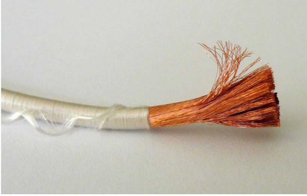
Şekil 2.17. Her biri 50 \mu\text{m} 'lik bir çapa sahip 2.000 iplikten oluşan örnek bir Litz tel. Her tel ince bir cila katıyla izole edilmiştir (Kaden 1959).
