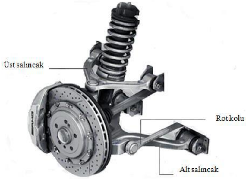
Şekil 2.4. Çift salıncaklı süspansiyonun parçaları (Putgül ve Altıparmak 2015)
