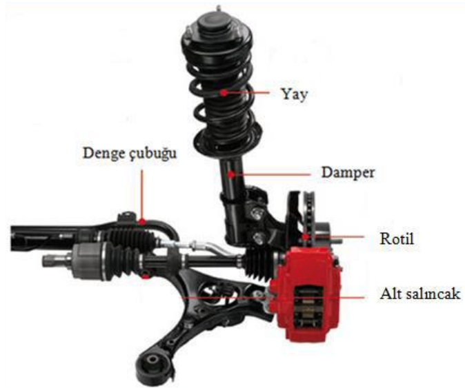
Şekil 2.5. Macpherson süspansiyonunun parçaları (Putgül ve Altıparmak 2015)
