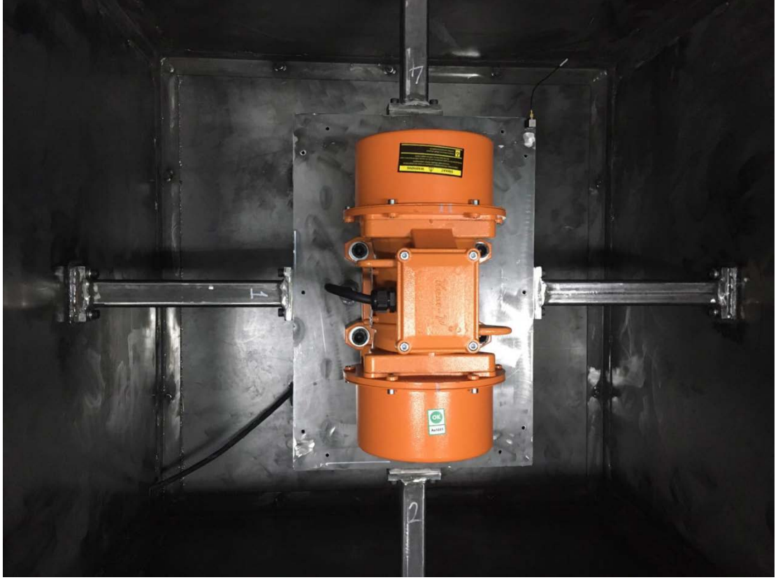
Şekil 3. 24. Titreşim Test Düzeneği İç Profilleri
