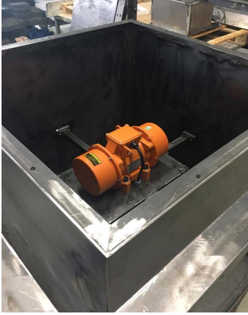
Şekil 3. 23. Titreşim Test Düzeneği Karkası
