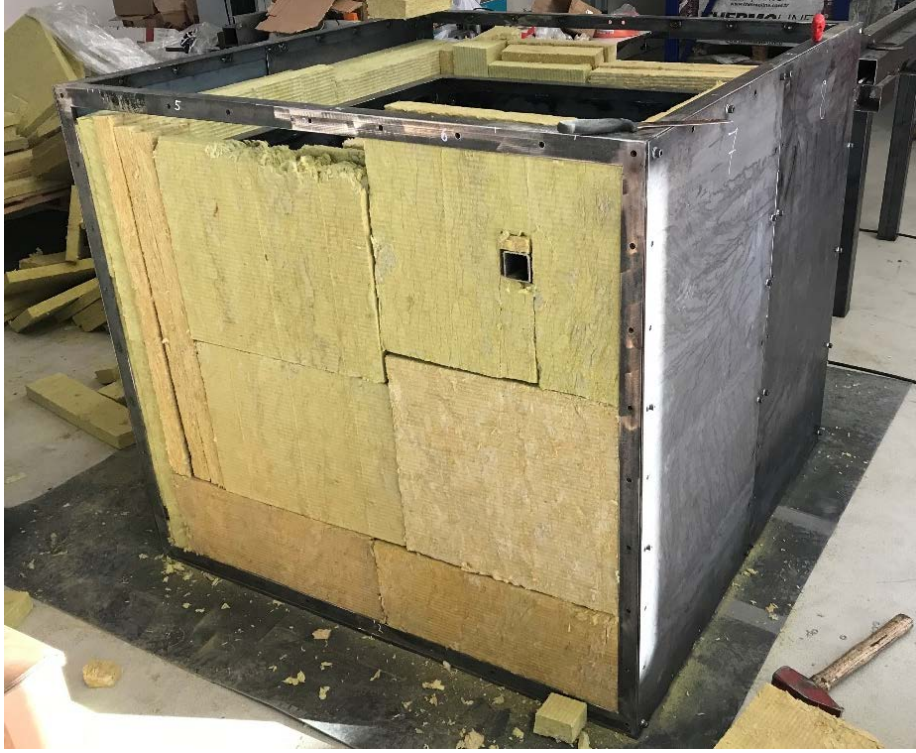
Şekil 4. 8. Titreşim Test Düzeneği Taş Yünü Dolgusu
