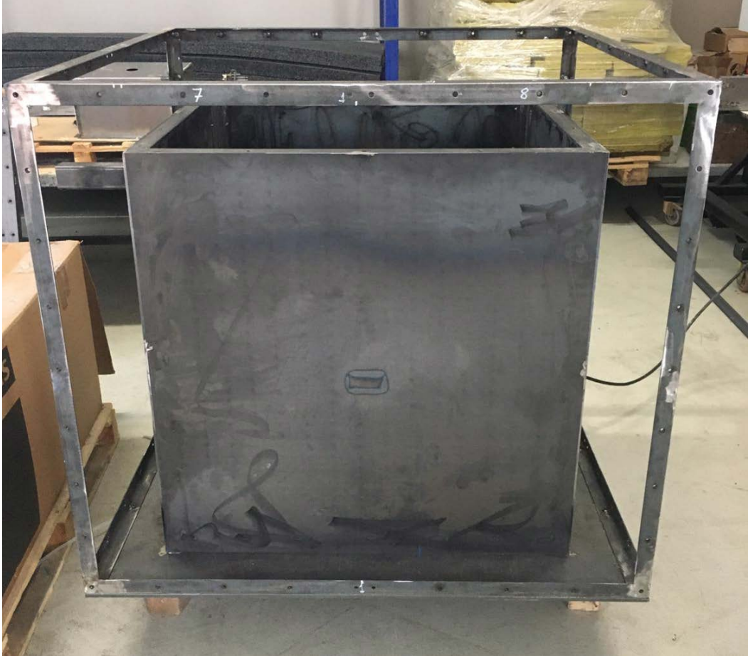
Şekil 3. 22. Titreşim Test Düzeneği Karkası
