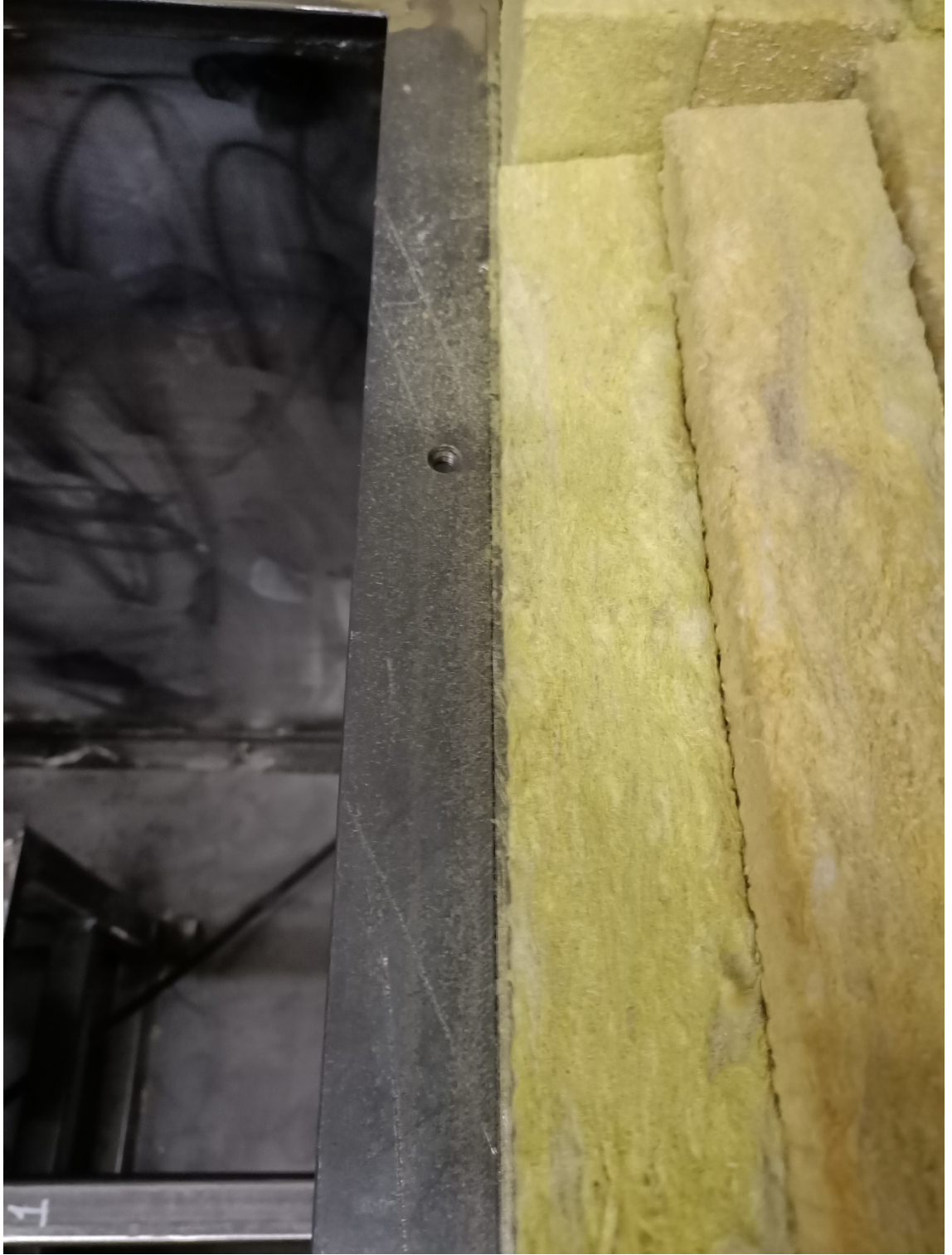
Şekil 4. 16. Yorulma Testi Sonrası Taş Yünü Malzemesi
