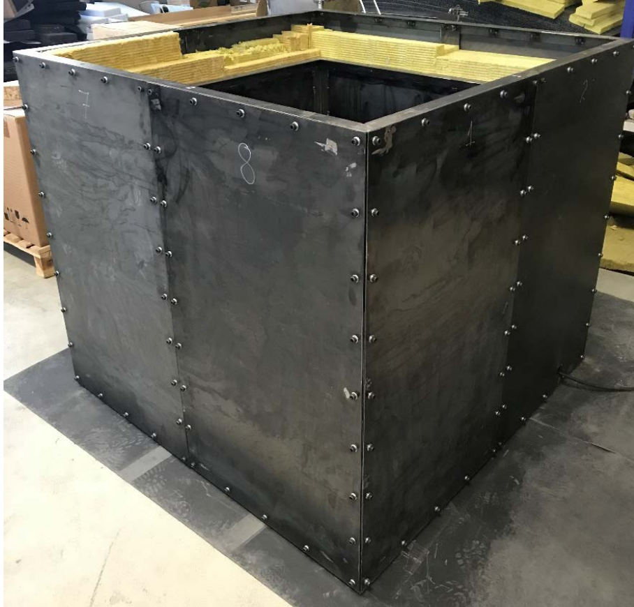
Şekil 4. 9. Titreşim Test Düzeneği Kapalı Hali
