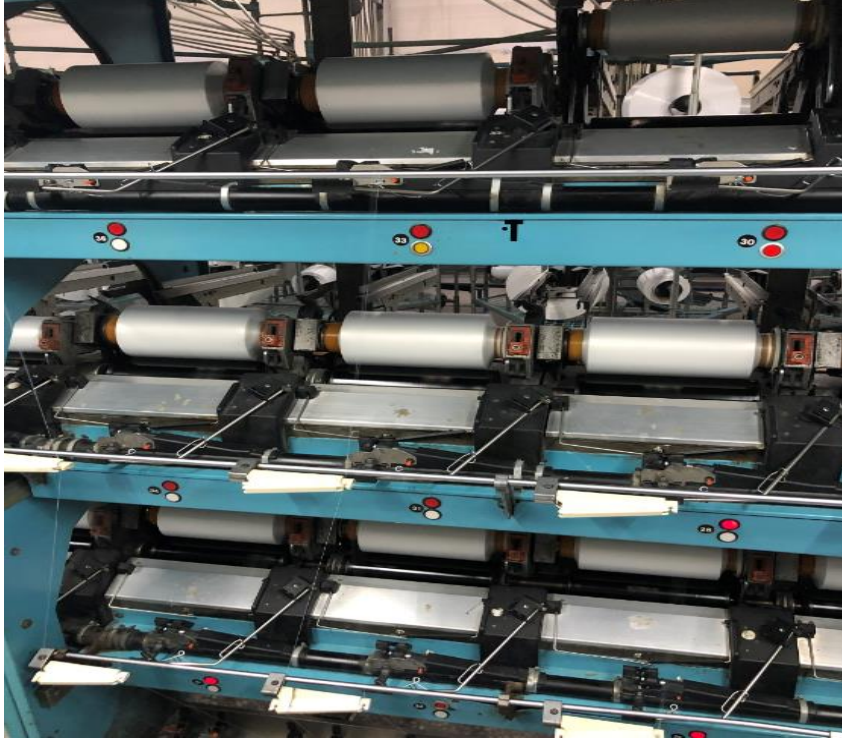
Şekil 2.9. Yalancı Büküm Tekstüre Makinası Sarım Ünitesi
