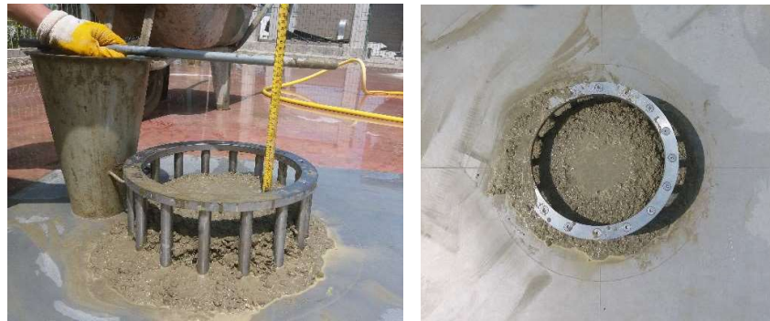
Şekil 4.14. J halkasının donatıları arasında lif içeren KYB karışımlarının tıkanması
