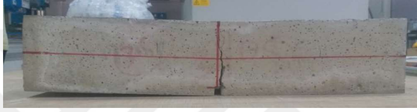
Şekil 4.22. Lif içeren KYB numunesi eğilme deneyinden sonra çatlak açılması
