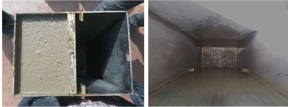
Şekil 4.12. U kutusunda lif içeren KYB karışımlarının tıkanması
