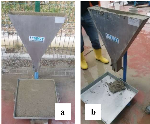
Şekil 4.6. KYB karışımlarının V hunisi akış süresi ölçümleri a. Kontrol karışımının (K) 60 dakikaya kadar V hunisi akışı sağlanması b. L30 karışımının 40 dakika sonra V hunisinden tıkanması
