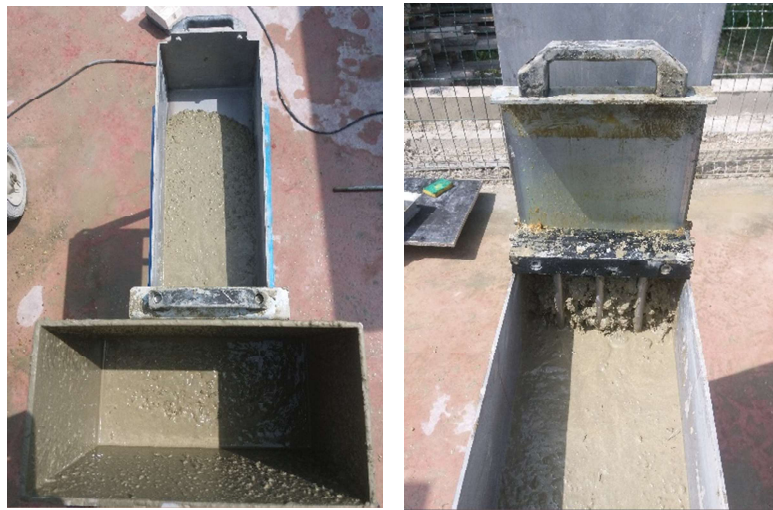
Şekil 4.8. L kutusunda çelik lif içeren KYB karışımlarının tıkanması
