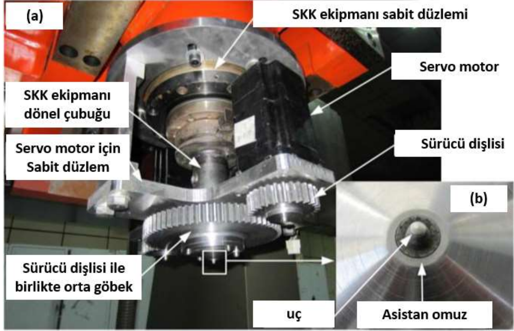
Şekil 2.9. Ters çift dönüşlü sürtünme karıştırma kaynağında uç sistemi görseli (J. Q. Li & H. J. Liu -2015).
