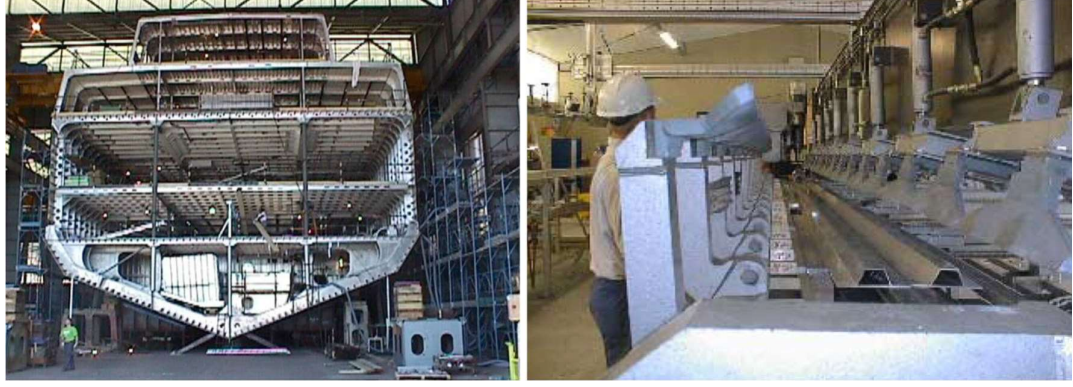
Şekil 1.3. Yüksek hızlı gemilerde kullanılan Al-Ekstrüzyon panellerinin SKK ile birleştirilmesi (Gürel Çam 2014).
