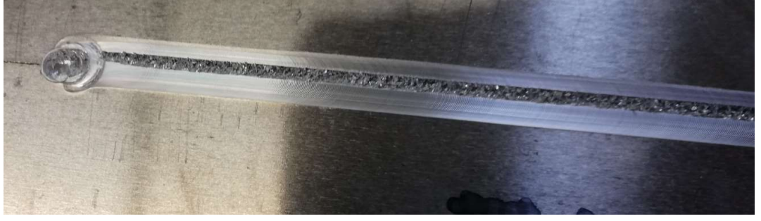
Şekil 2.8. Sabit omuzlu sürtünme karıştırma kaynağı ile kaynaklanmış bir örnek görseli.
