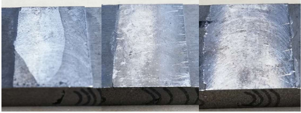
Şekil 4.1. Soldan sağa doğru 1-2-3. kaynaklar (600 RPM 200-100-50 mm/dk).
