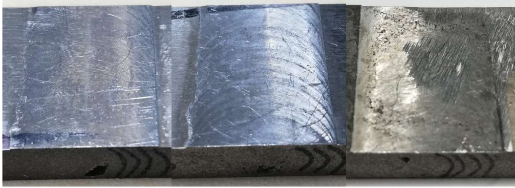
Şekil 4.2. Soldan sağa doğru 4-5-6. kaynaklar (1200 RPM 200-100-50 mm/dk).
