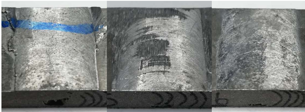
Şekil 4.3. Soldan sağa doğru 7-8-9. kaynaklar (1600 RPM 200-100-50 mm/dk).
