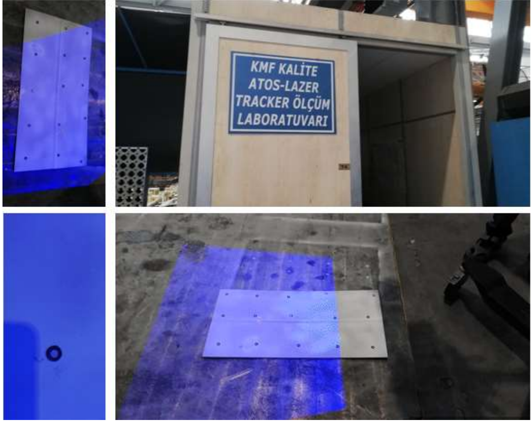
Şekil 4.30. ATOS cihazı ile yüzey tarama işleminin görüntüsü.
