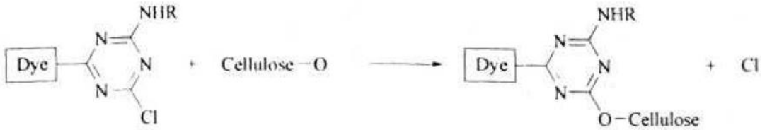
Şekil 2.13. Monoklortriazin reaktif boyarmaddelerinin selülozik liflerle nükleofilik substitüsyon reaksiyonu
