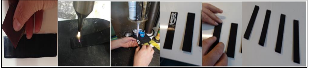
Şekil 3.11. Yapılan işlemler (Atmosferik plazma+Zımpara yüzey işlem uygulanmış)
