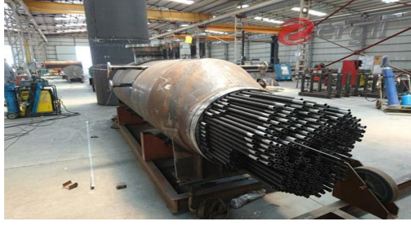
Şekil 2.2. Kimya sanayi için ısı deęiřtirici
