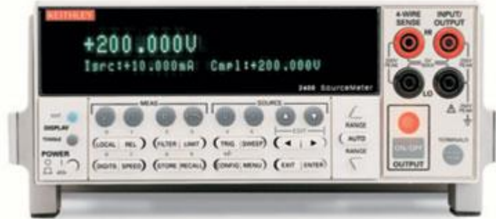
Şekil 4.4. Keithley 2400 akım-gerilim karakterizasyon cihazı (Anonim i,2019).
