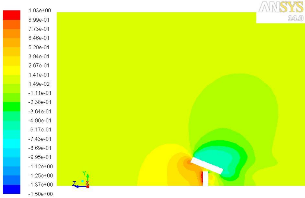
Şekil 4.121. 25° panel eğim açısı ve 20 m/s rüzgar hızı için basınç katsayıları
