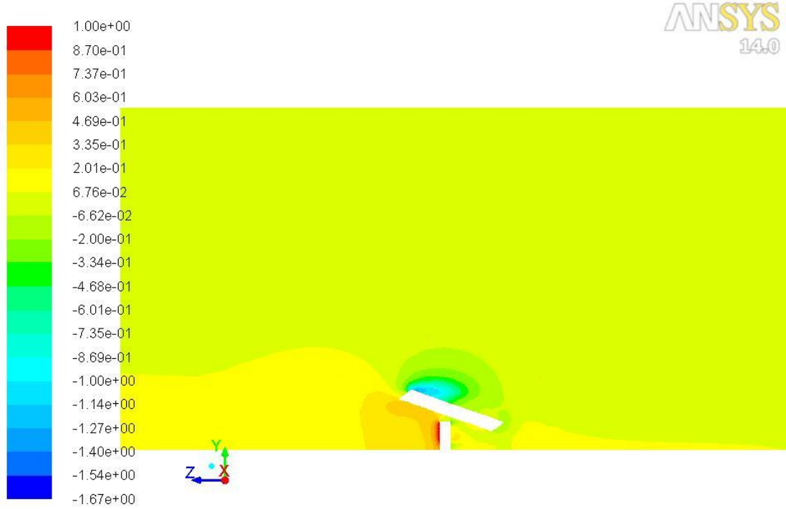
Şekil 4.100. 35° panel eğim açısı ve 20 m/s rüzgar hızı için basınç katsayıları
