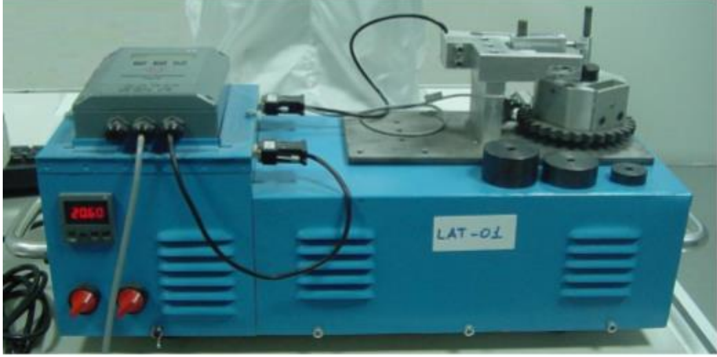
Şekil 3. 1. Ball-on-disc aşınma test cihazı
