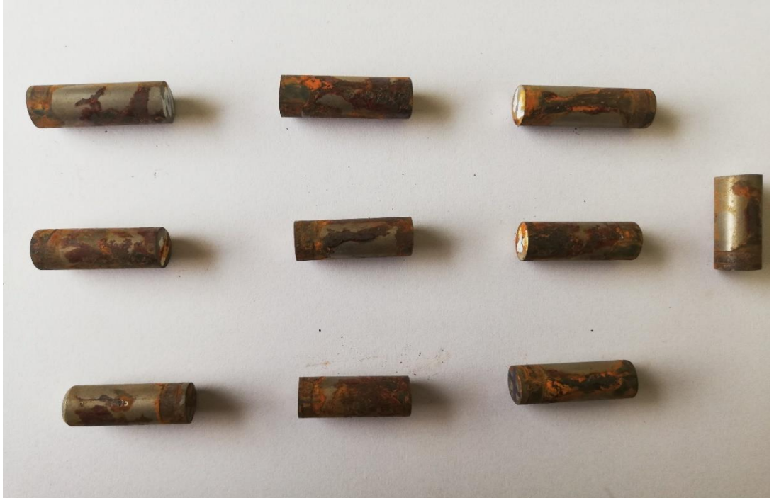
Şekil 4. 38. PN450 korozyon numunelerinin tuzlu sis testi sonrası genel görünümü
