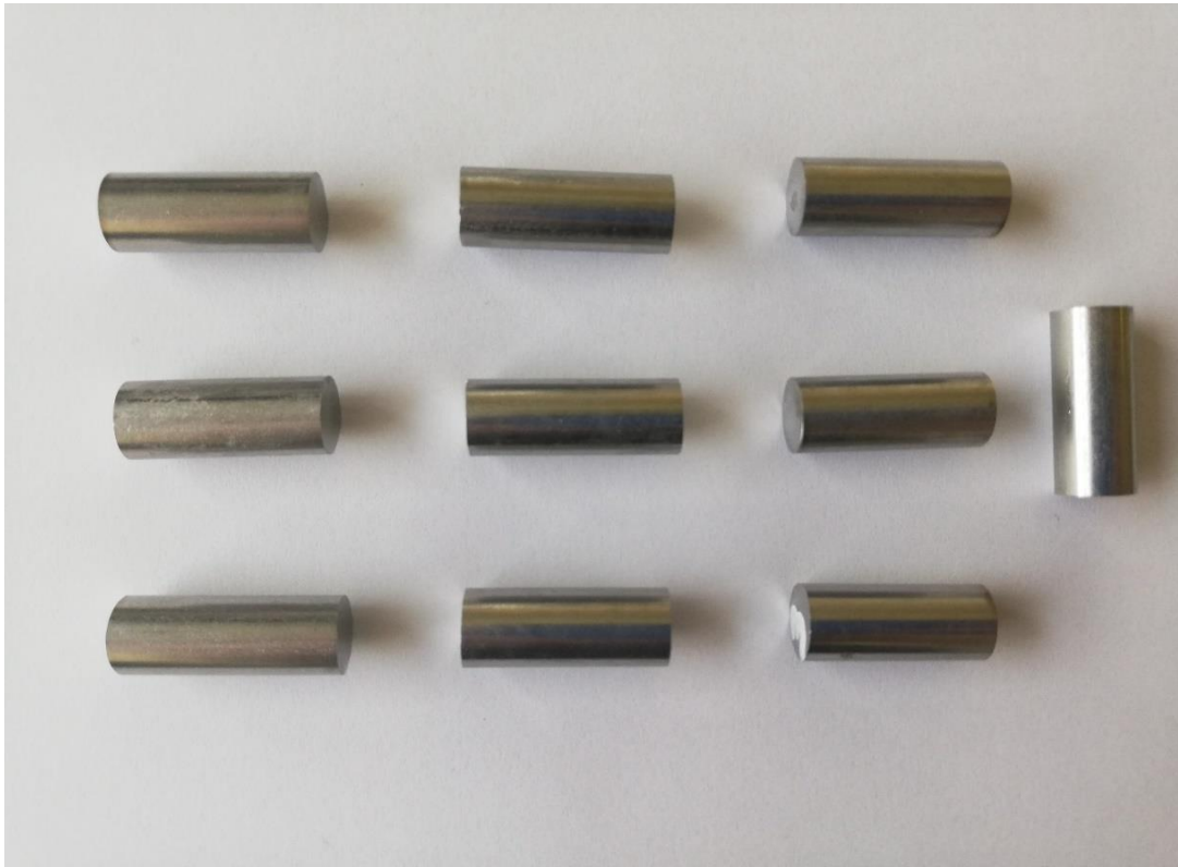
Şekil 4. 36. BM korozyon numunelerinin tuz sis testi sonrası genel görünümü
