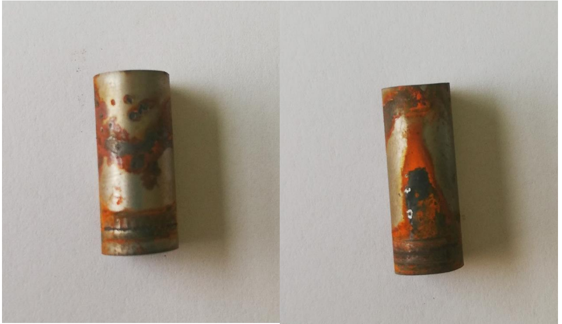
Şekil 4. 40. PN400 korozyon numunelerinin tuzlu sis testi sonrası oluşan oyuklu korozyonun genel görünümü
