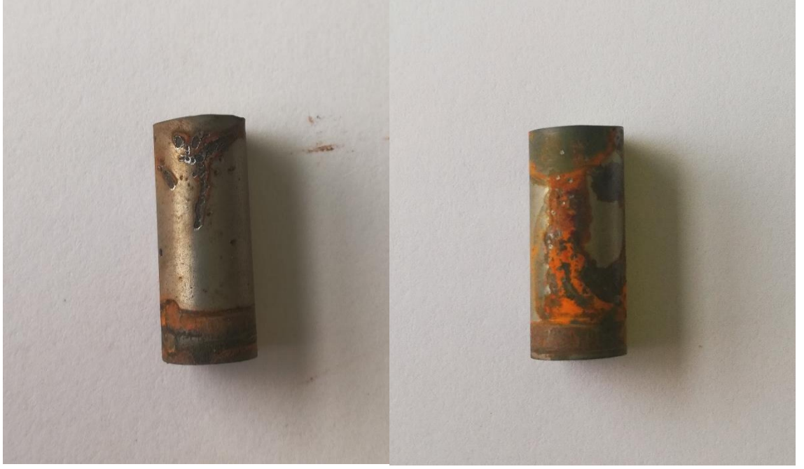
Şekil 4. 39. PN450 korozyon numunelerinin tuzlu sis testi sonrası oluşan oyuklu korozyonun genel görünümü
