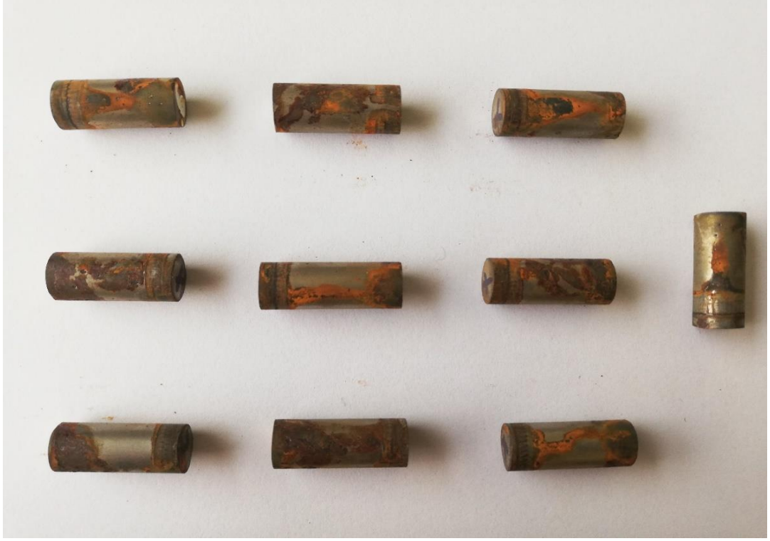
Şekil 4. 37. PN400 korozyon numunelerinin tuzlu sis testi sonrası genel görünümü
