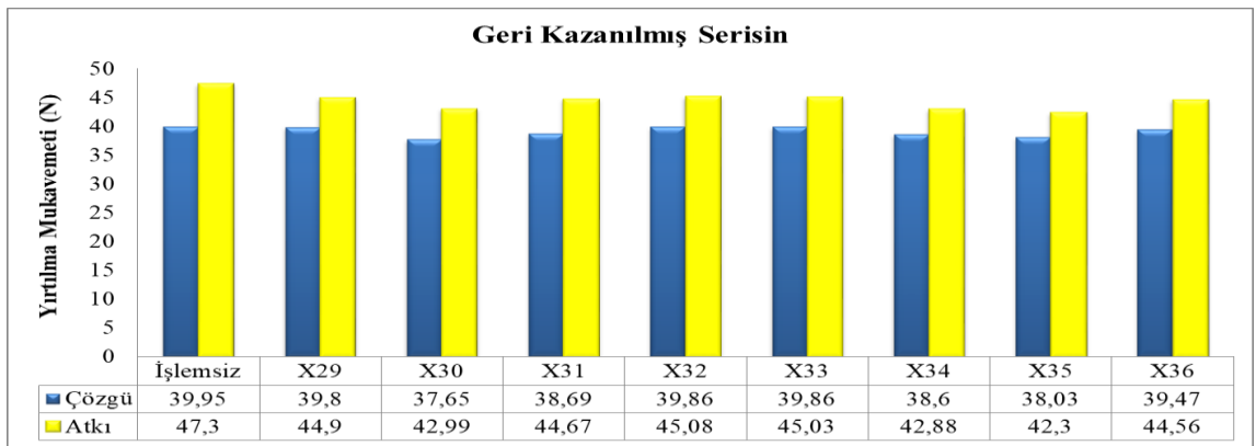
Şekil 4.25. Ham pamuk ve geri kazanılmış serisin uygulanmış pamuklu kumaşların atkı ve çözü yönündeki yırtılma mukavemeti değerleri
