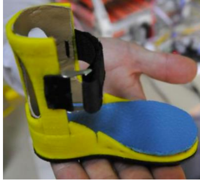
Şekil 2.7. 3D yazıcıların medikal alanda kullanım örneği; kişiye özel ayak ortezi (Aydın ve Küçük 2017)
