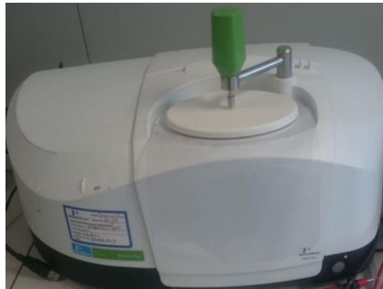
Şekil 3.7. Ölçümlerin yapıldığı Perkin Elmer Spectrum Two FTIR cihazı
