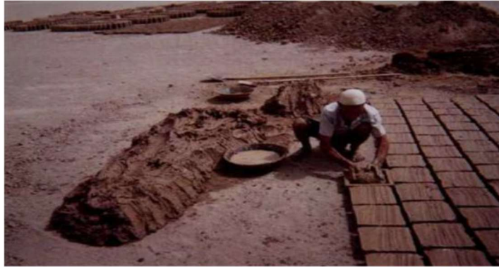
řekil 2.7. Kerpiç blokların kalıplanma řekli
