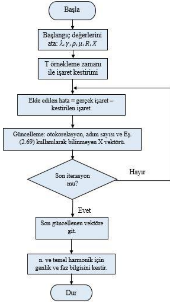
Şekil 3.10. Normalleştirilmiş en küçük ortalama kare algoritmasına ait akış diyagramı
