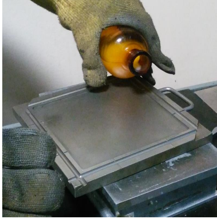
Şekil 3. 8. Kalıp plakasına kalıp ayırıcı dökülmesi
