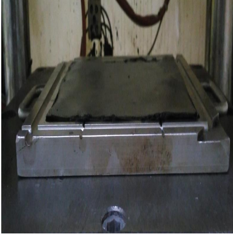
Şekil 3. 10. Kauçuk hamurun vulkanizasyon kalıbına yerleştirilmesi
