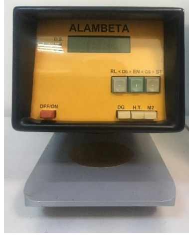
Şekil 3.6 Isıl geçirgenlik ölçümlerinin yapıldığı Alambeta cihazı
