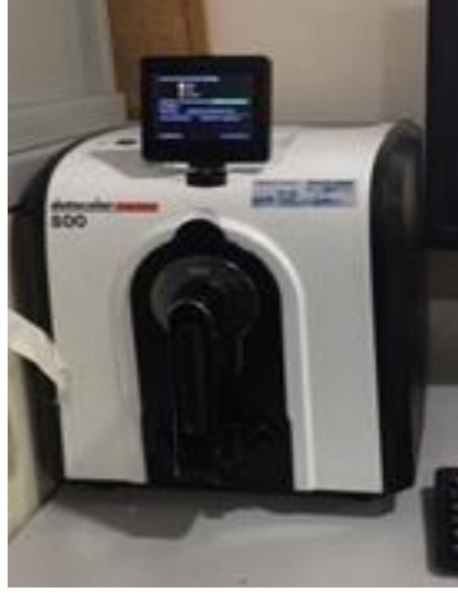
Şekil 3.3 Renk ölçümlerinin gerçekleştirildiği Datacolor 800 marka spektrofotometre
