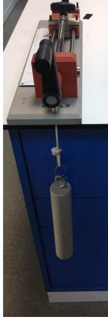
Şekil 3.7 Uzama testlerinin yapıldığı Fryma marka kumaş ekstansiyometresi
