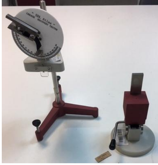
Şekil 3.8 Kat düzelme açu ölçümlerinin yapıldığı SDL ATLAS M003B marka ölçüm cihazı
