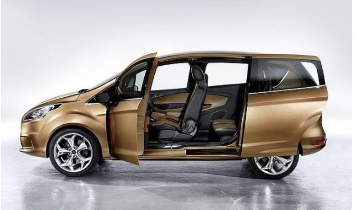
Şekil 3.2. Kayar kapı sistemi (Kranz 2019)
