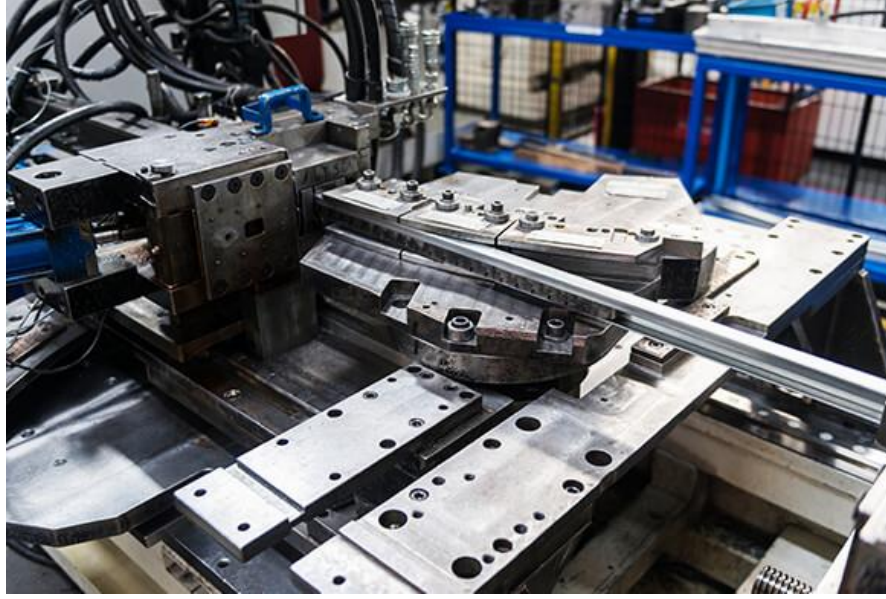
Şekil 3.12. Gerdirerek şekillendirme ile kızak üretimi (Rollmech 2019)
