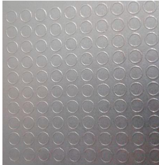
Şekil 3.18. Kimyasal yöntem ile hazırlanmış sac malzeme (Shinge ve ark. 2018)
