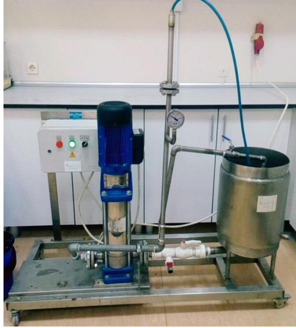
Şekil 3.1. Tez çalışması kapsamında kullanılan hidrodinamik kavitasyon sistemi
