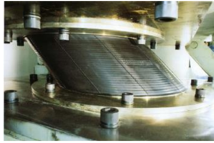
Şekil 2.17 Yüksek sönümlü kauçuk izolatör (Yücesoy 2005)
