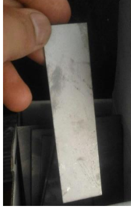
Şekil 3.1. Kaynak işlemleri öncesi kesilmiş olan numune örneği
