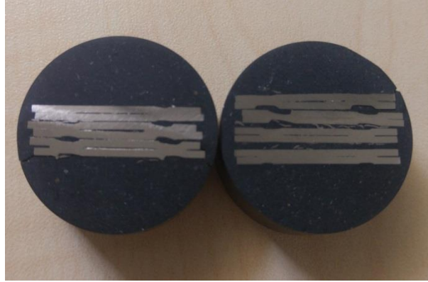
Şekil 3.8. Bakalite alınmış sertlik ölçüm numunesi
