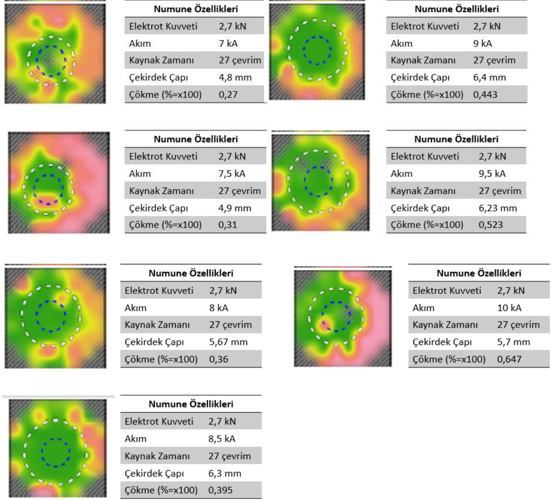
Şekil 4.2. Kaynak akımı değişimine göre ultrason kontrol örnekleri
